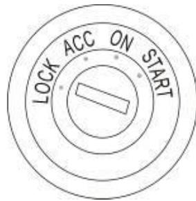
**方向盘解锁：**将钥匙插入点火开关，轻轻左右转动方向盘，同时慢慢转动钥匙即可解锁。
