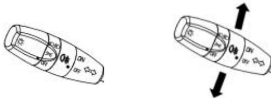
旋钮位于“
