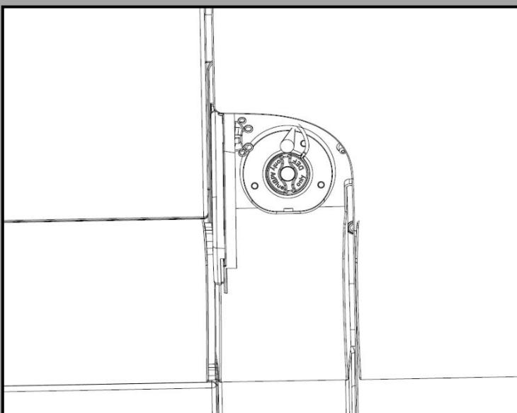
3、逆时针方向缓慢拧开尿素口盖【5】，插入尿素加注枪加注尿素，尿素加满跳枪后可每隔两秒钟进行少量补充加注。加注结束后按顺时针方向拧紧尿素口盖【5】
