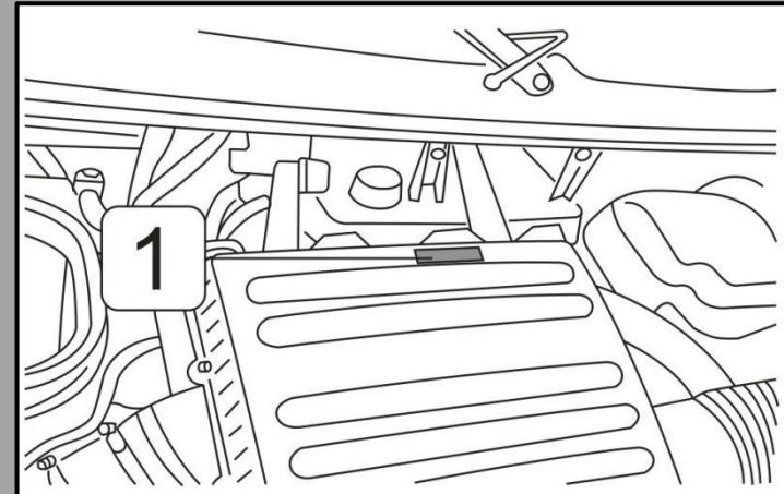
M1 车型 VIN 码【1】粘贴在前梁中部（前横置板簧前桥）。
