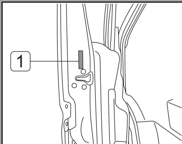
M1 车型 VIN 码【1】粘贴在驾驶员门侧面。
