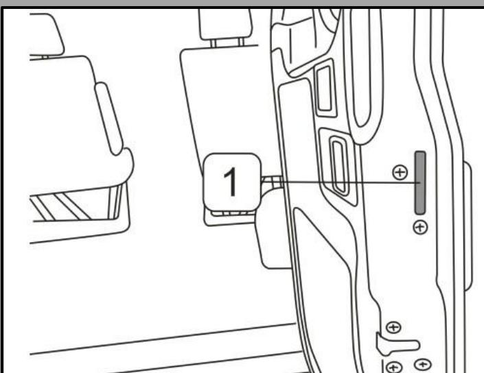
M1 车型 VIN 码【1】粘贴在后右开门门框侧面。
