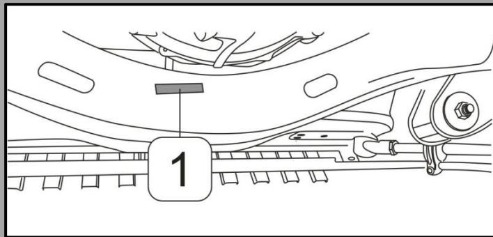
M1 车型 VIN 码【1】粘贴在前梁中部（前扭杆弹簧前桥）。
