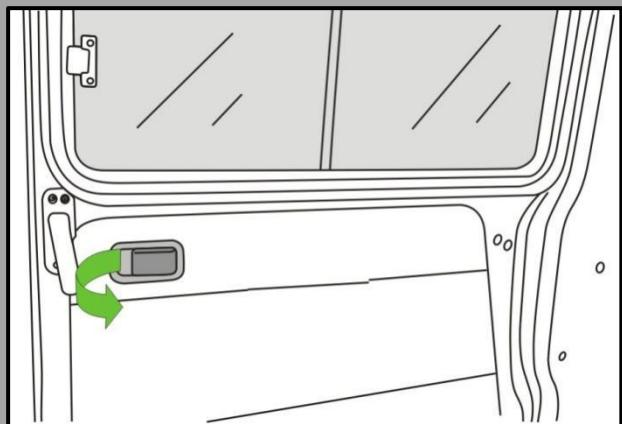
移门内手柄控制开关：位于侧拉门内板上。
