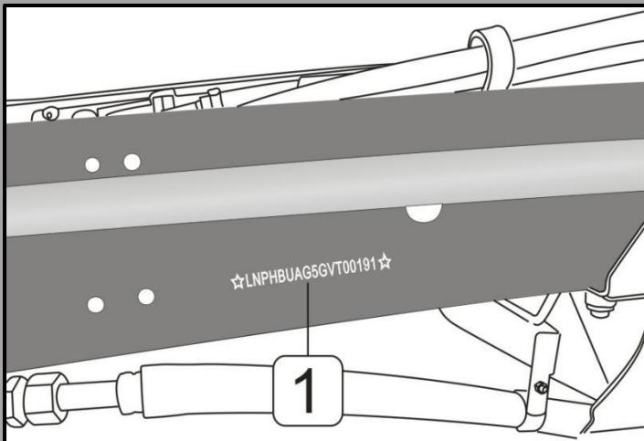
所有车型 VIN 码【1】打刻在车架纵梁右前部，打码区域涂以保护性油脂。
