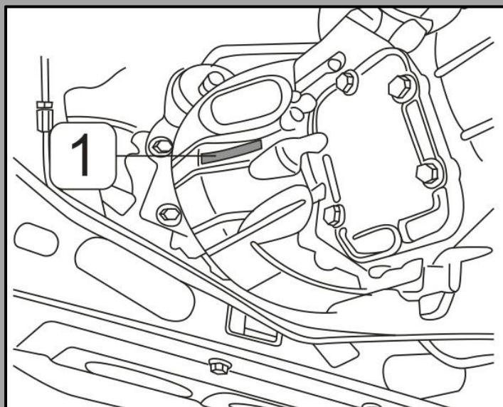
M1 车型 VIN 码【1】粘贴在变速器上。
