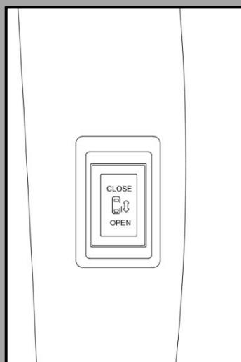
B柱控制开关：位于车内，侧拉门前立柱上。
