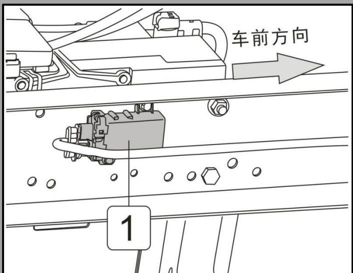
胎压控制器【1】在车架纵梁内侧，靠近蓄电池。
